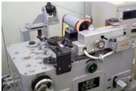
図4 大越式迅速摩耗試験機
