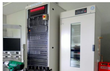
充放電試験装置 (20V 100A まで対応)
