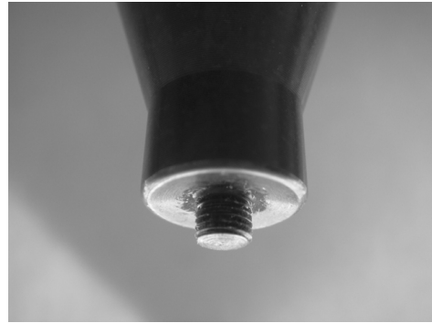
図 2 汎用形状の FSW ツール (ショルダ径は 12 mm)
