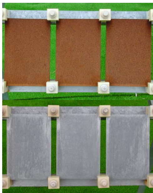
図3 暴露開始2ヶ月後の炭素鋼板(上)と亜鉛板(下)
