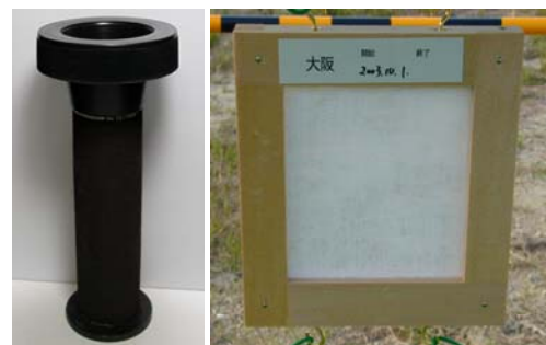
図2 硫黄酸化物を測定する二酸化鉛円筒（左）と海塩粒子を測定するドライガーゼ（右）
