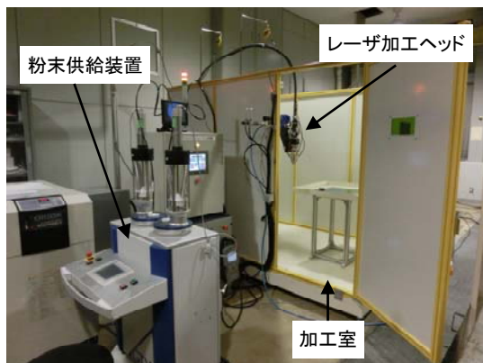
図2 装置全体の外観
