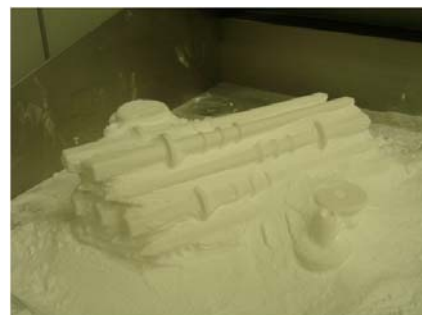
図2 SLS造形における造形物掘り出し(アンパッキング)作業
