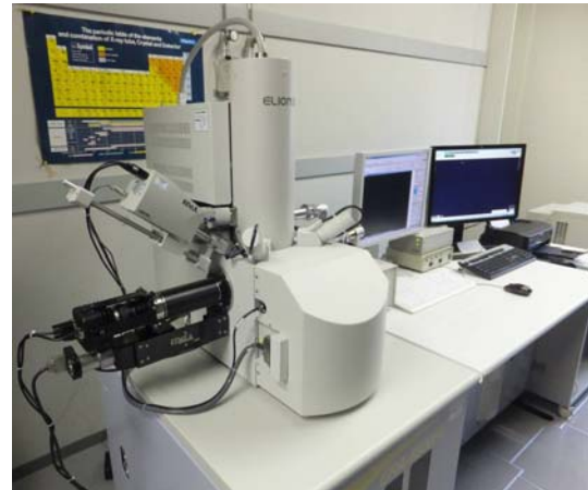
図 1 電子線三次元表面形態解析装置
