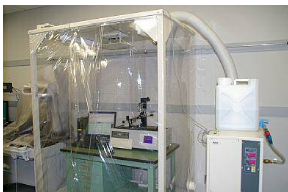
図 4 恒温恒湿度制御装置
