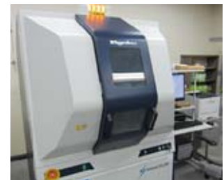
機器名：全自動水平型多目的 X線回折装置“SmartLab” 株式会社リガク
