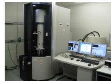
機種名：日立HD-2700(球面収差補正機能付) EDS：EDAX Genesis XM2 EELS：日立 EV3000
