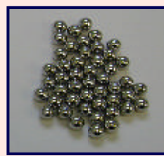
バレルめっきによるNi-W合金めっき例 (数μm)
