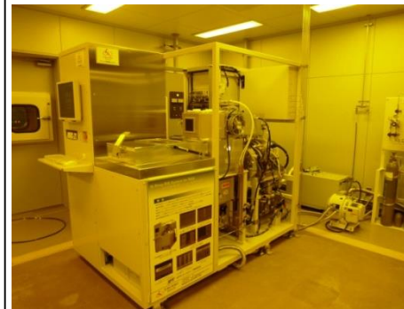
高速シリコンディープエッチング装置
