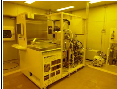
高速シリコンディープエッチング装置
