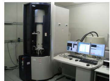
走査透過電子顕微鏡(日立 HD-2700)
