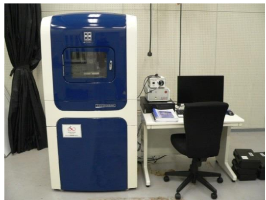
ナノインデント (HYSITRON 社製 TI 950 TriboIndenter)
