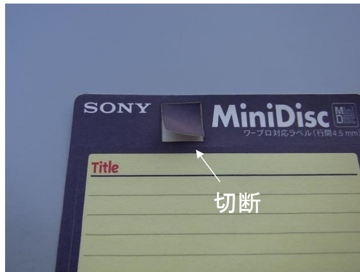
シールのハーフカット レーザパワー8W, 切断速度10mm/s
