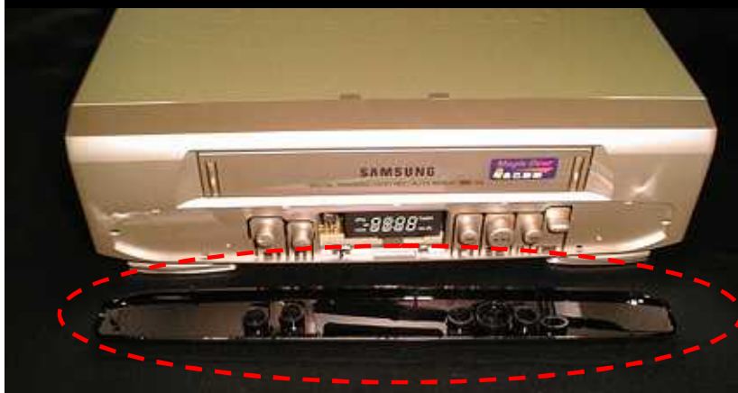
前面化粧板の脱落
